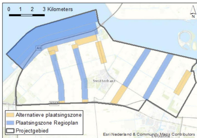
Figuur 1, plaatsingszones windturbines uit het Regioplan (blauw) en in het kader van het MER windplan Blauw onderzochte alternatieve zones (in geel), bron: MER.
